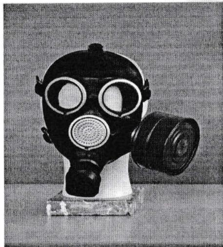
Фильтрующий противогаз ГП-7 состоит из фильтрующе-поглощающей коробки ГП-7К, лицевой части МГП, незапотевающих пленок (10 шт.), утеплительных манжет, защитного трикотажного чехла и сумки. Вес противогаза в сборе – 900 г.
