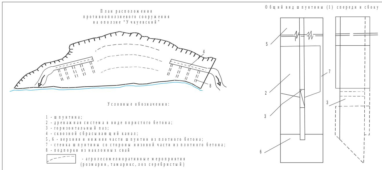
Рис.2. Схема размещения противооползневое сооружения в пределах оползня «Учкуевский» (по результатам выполнения проекта)
