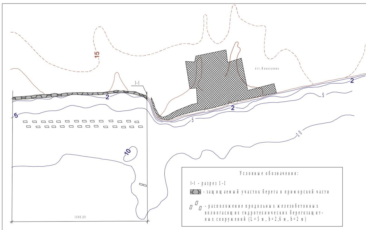
Рис. 3. Схема размещения продольных гидротехнических берегозащитных сооружений в бухте пгт. Николаевка (по результатам выполнения проекта)
