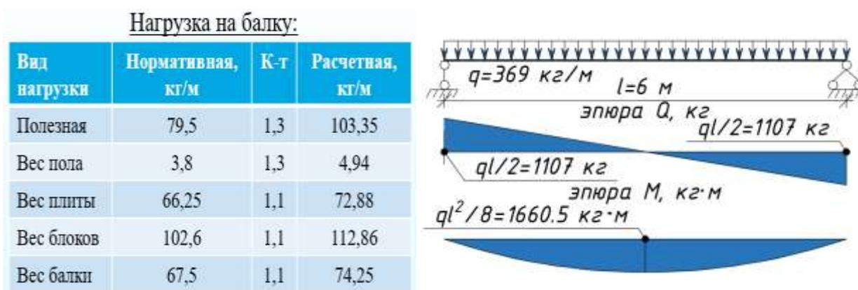
Рис. 2. Сбор нагрузок на балку, расчетная схема балки
