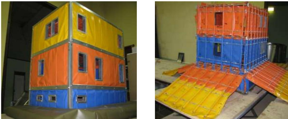
Рис. 2. Макет текстармированного каркаса трёхуровневого здания
